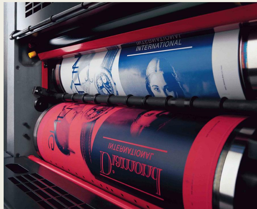
Offsetlitografi, här använder man metallvalsar för att trycka i stora upplagor.
